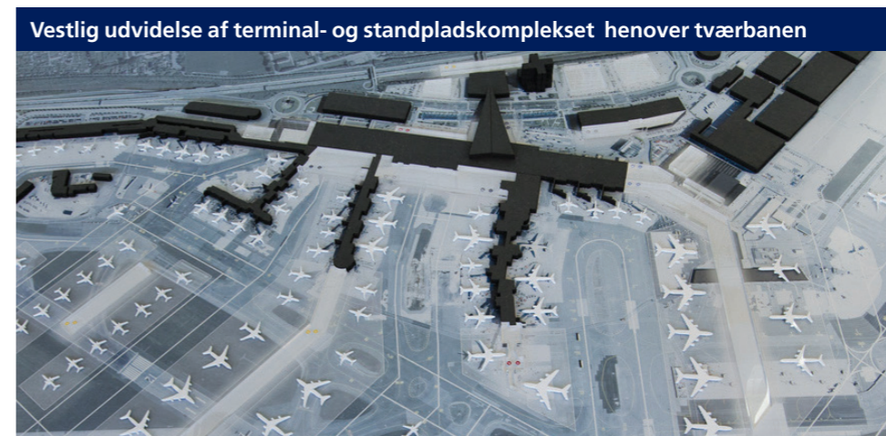
Figur 0.2: Illustrationen viser den vestlige udvidelse af terminal- og standpladskomplekset henover tværbane 12/30. Eksisterende bygninger er vist i gråt. Nye terminaler, fingre og standpladsområder fremgår i transparent hvid.
